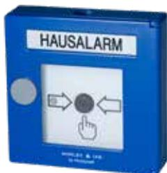
Aufschrift: Hausalarm. In Aluminium-Druckguss mit integriertem Überwachungsmodul, roter LED und beidseitigem Isolator zur automatischen Isolierung von Ringabschnitten bei Kurzschluss der Ringleitung.
