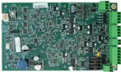
Geeignet für den Einbau in DXc1-M und DXc2-M. Notwendig für die Aufschaltung der Feuerwehrperipherie.
